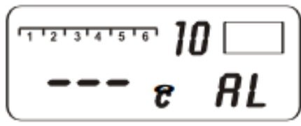
Рисунок 5. Индикация при обрыве термопары.
