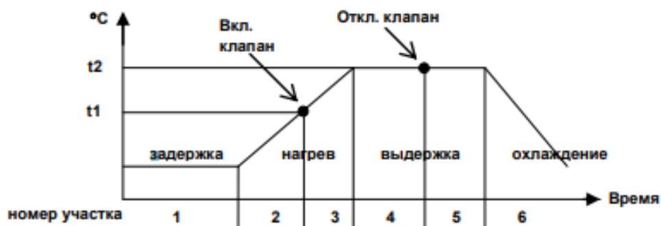
Рисунок 7. Термическая программа с задержкой и дополнительной коммутацией.
