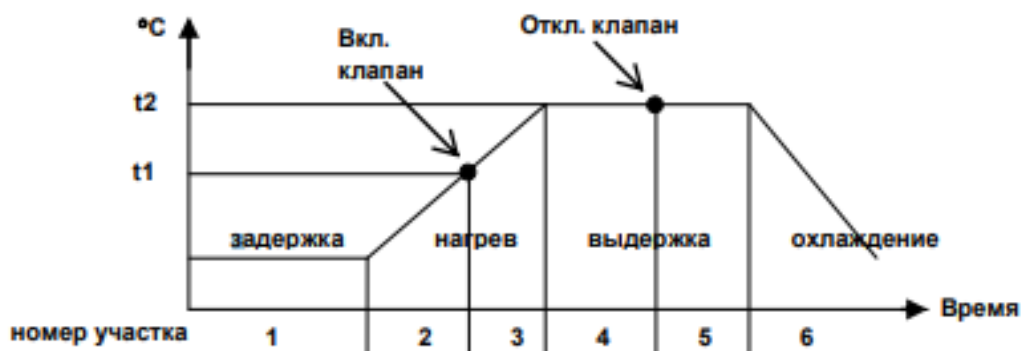
Рисунок 7. Термическая программа с задержкой и дополнительной коммутацией.
