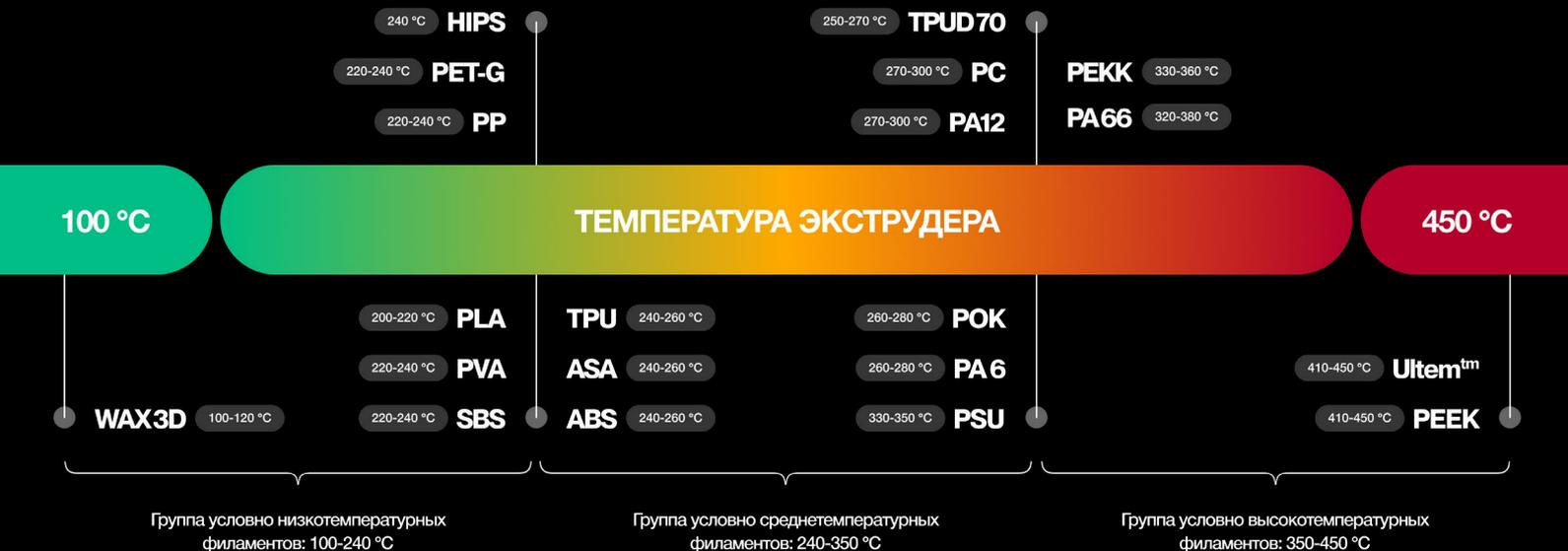
Данные о температурных режимах работы экструдеров являются усреднёнными для представленных материалов. Возможны изменения температуры в зависимости от производителя пластика. Для уточнения параметров печати обратитесь в техподдержку Volgobot.
